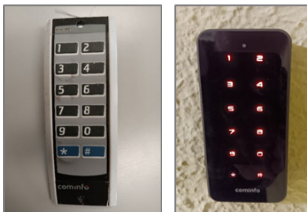
Obrázek 6 - Obměna čtecích hlav přístupového systému
